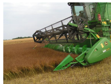
Fig.4. Les rabatteurs doivent être relevés.
