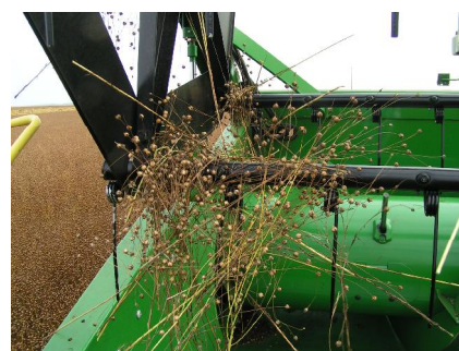
Fig.5. Pour éviter que le lin ne s'enroule sur les rabatteurs, ils ne doivent pas toucher les plantes.
